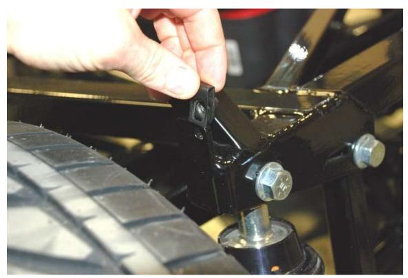
Push the U-nut onto the frame mount.
